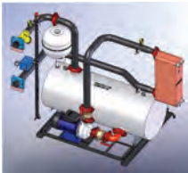
Гидро модуль с одним насосом 1sp или 1hp, с аккумулирующим баком
