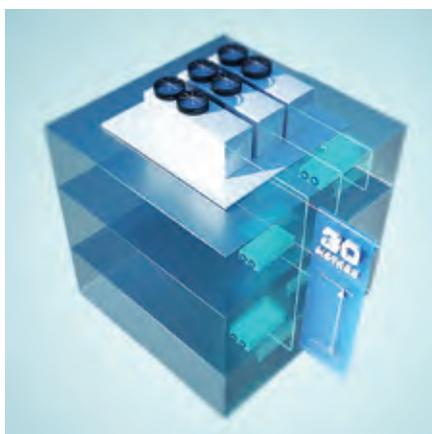
Протяженные трассы в системе (до 50 м) и перепад высот (до 30 м) обеспечивают гибкий монтаж и применение ККБ на объектах.
