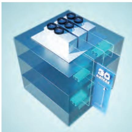
Протяженные трассы в системе (до 50 м) и перепад высот до 30 м обеспечивают гибкий монтаж и широкое применение ККБ на объектах.
